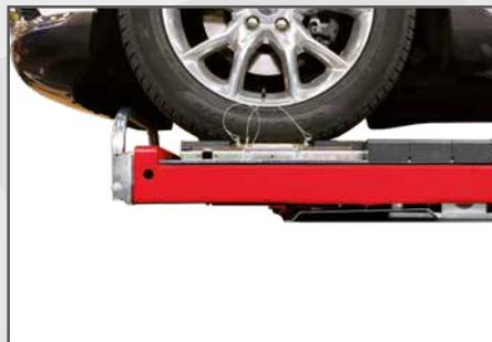
**8. Doppeltes Hubgestänge** zur Gewährleistung einer ständigen Parallelität des Hubs.
