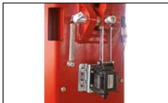
Entriegelung der Sicherungen mit **Elektromagnet 24V.**
