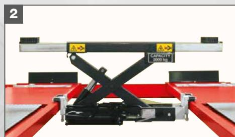
**2.** Traversa idraulica portata 2000 Kg, pneumatica (a richiesta).
