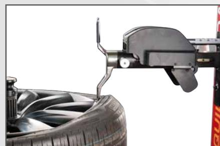
**LA ROTACIÓN MANUAL DE LA HERRAMIENTA PERMITE PASAR DEL MODO DESMONTAJE A MONTAJE CON EXTREMA FACILIDAD Y RAPIDEZ.**
