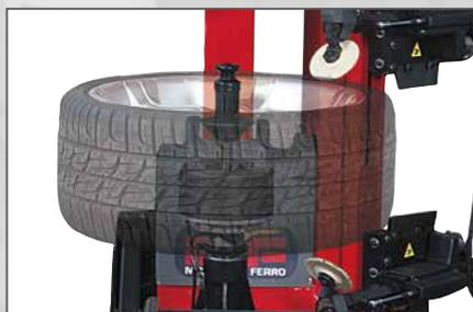
El pedal se utiliza en la fase de preparación y bloqueo de la rueda en el autocentrante y **al finalizar la tarea** para liberarla (ya usada en el modelo Raptor).
