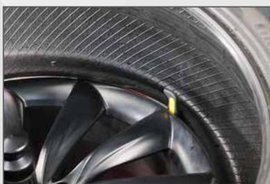
La fase de montaje del segundo talón se completa con el **uso simultáneo del disco destalonador**, la rotación del autocentrante y, **en caso de neumáticos rebajados o RFT**, con el uso del Press Mate que garantiza la permanencia del neumático en el canal de la llanta.
