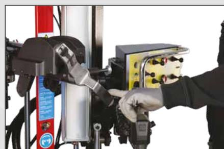
**OPERACIÓN DE DESMONTAJE DEL TALÓN INFERIOR CON LA AYUDA DEL DISCO DESTALONADOR INFERIOR.**
