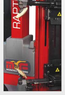
**8-9-10.** Dispositivo de desmontaje SIN PALANCA, aplicado al sistema de extracción, que elimina completamente el esfuerzo físico del operador y garantiza la máxima seguridad para la llanta y el neumático.
