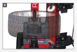
**4. Bloqueo del neumático integrado** que permite un fácil posicionamiento de la rueda en el autocentrante, sin ningún esfuerzo y permite destalonar los dos talones con un único movimiento, sin tener que girar la llanta.
