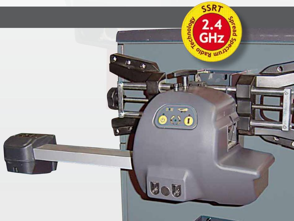
Los medidores utilizan el sistema de medición CCD y cuentan con **8 sensores para la medición perimétrica de los ángulos, de las medidas adicionales y del eje de empuje real del vehículo**. La puesta a nivel de los medidores es electrónica.
