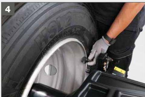
Système intelligent d'acquisition automatique de la distance, diamètre 28" avec fonction intégrée AUTOSELECT activant automatiquement les programmes d'équilibrage et ne nécessitant pas de sélections depuis le clavier.
