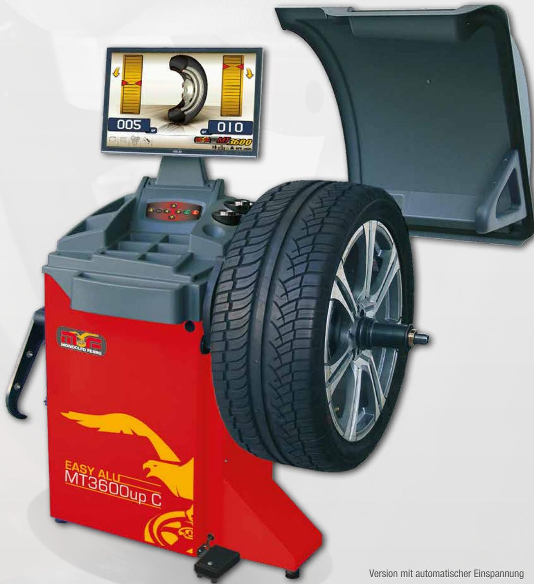
Version mit automatischer Einspannung
