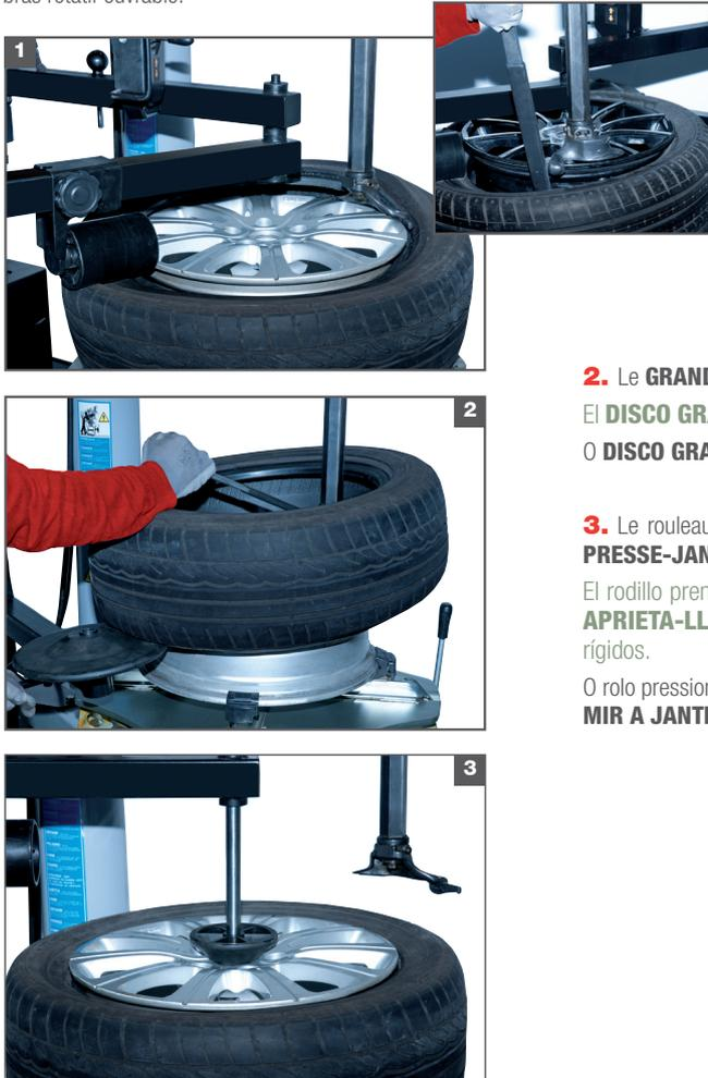
**1. ROULEAU PRESSE-TALON.** Il facilite les opérations de démontage et de montage du premier talon, en maintenant celui-ci dans le creux de la jante. Il rend la phase de démontage du second talon plus aisée.
