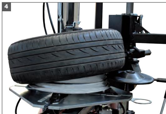
4. Le **GRAND DISQUE** permet de soulever le pneu et de détacher le talon inférieur.
