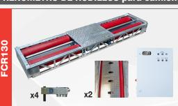
Banda de rodiamento: 800-2.800 mm Diámetro del rodillo: 205 mm Velocidad de ensayo: 2,6 Kmh Potencia de frenado: 32 kN Motores: 2 x 7,5 kW Capacidad de prueba de carga: 12 t Voltaie: 3Ph/400V/50Hz
