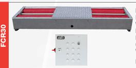
Banda de rodiamento: 820-2.160 mm Diámetro del rodillo: 167 mm Velocidad de ensayo: 2,6 Kmh Potencia de frenado: 6 kN Motores: 2 x 2,4 kW Capacidad de prueba de carga: 2,6 t
