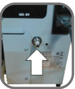
INGRESSO ARIA COMPRESSA
