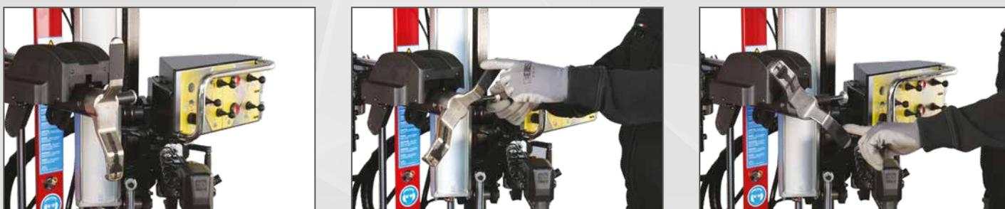
**OPERAZIONE DI SMONTAGGIO TALLONE INFERIORE CON L'AUSILIO DEL DISCO STALLONATORE INFERIORE**
