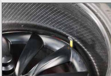
La fase di montaggio del secondo tallone si completa con l'**utilizzo contemporaneo del disco stallonatore**, la rotazione dell'autocentrante ed **in presenza di pneumatici ribassati** o RFT con l'utilizzo del Press Mate che garantisce allo pneumatico di restare nel canale del cerchio.
