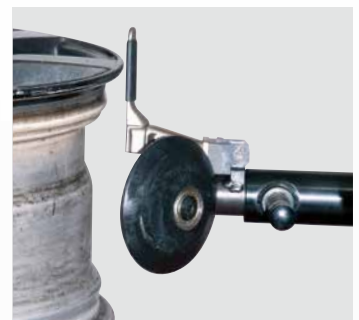
HERRAMIENTA INFERIOR DE ACCIONAMIENTO MANUAL
