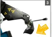
Une autre innovation importante réside dans l'introduction d'un **réglage de l'inclinaison de la palette de détalonnage**. Ce réglage agit dans deux directions différentes, haut-bas et intérieur-extérieur. Grâce à ces réglages, la palette de détalonnage sera toujours dans la meilleure position possible.
