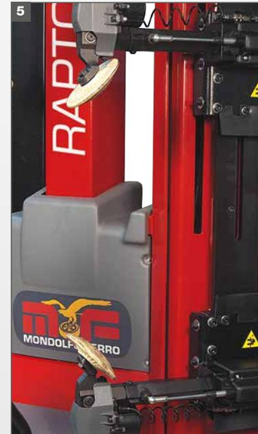
**8-9-10.** Dispositif de démontage **SANS LEVIER**, appliqué au système d'extraction, **il permet d'éliminer complètement l'effort physique de l'opérateur et assure le maximum de sécurité pour la jante et le pneu.**
