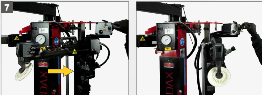
7. Gruppo Stallonatore Movimento ad azionamento pneumatico di apertura laterale del braccio per consentire il posizionamento sul fianco inferiore
