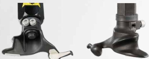
Utensile scorrevole a discesa e bloccaggio pneumatico, con sezione maggiorata (60mm x 60mm) per aumentare la rigidità di torsione in fase di sforzo. La testa del piantone è di tipo brocciato, con rullino per facilitare la scorrevolezza dell'albero orizzontale ed è regolabile per mantenere le prestazioni nel tempo.
