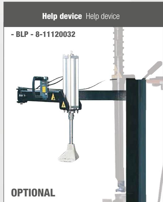
DIE HÖHENVERSTELLBARE VORRICHTUNG arbeitet nur in der Phase, **in der der Reifenwulst von oben abgedrückt wird.**
